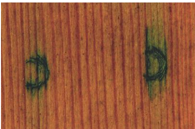
Χωρίς χρήση γαλακτώματος συντήρησης: Μέσα από τις μικρορωγμές διεισδύει νερό και δημιουργείται κυάνωση.
