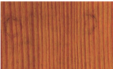
Με τη χρήση γαλακτώματος συντήρησης: Οι μικρορωγμές σφραγίζονται. Το νερό δε μπορεί να διεισδύσει.
